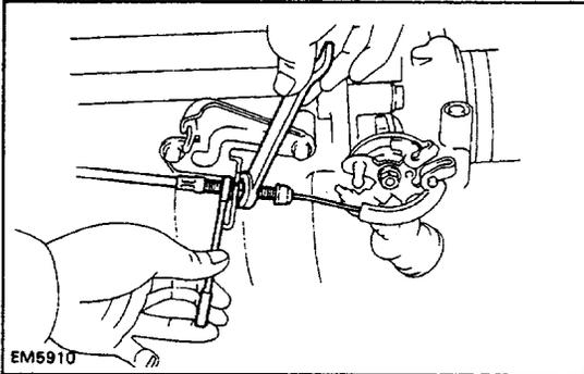
**11. CONNECT GROUND STRAP TO ENGINE REAR SIDE**
