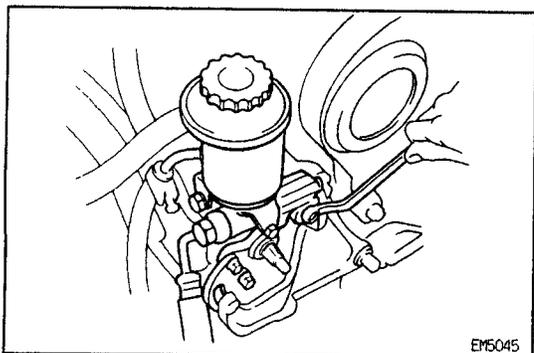
**8. REMOVE PS DRIVE BELT AND PUMP PULLEY**
