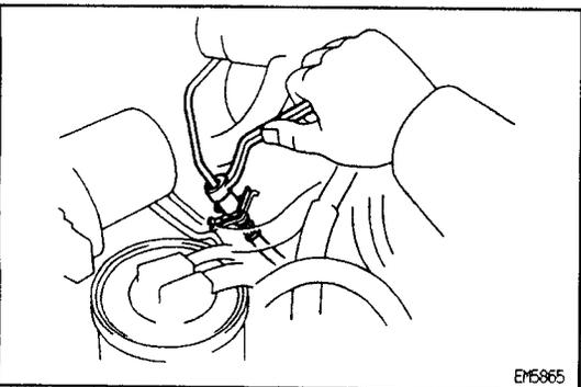
10. REMOVE PS DRIVE BELT AND PUMP PULLEY
