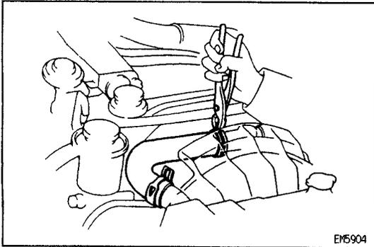
(d) Remove the two clips and No.2 fan shroud.
