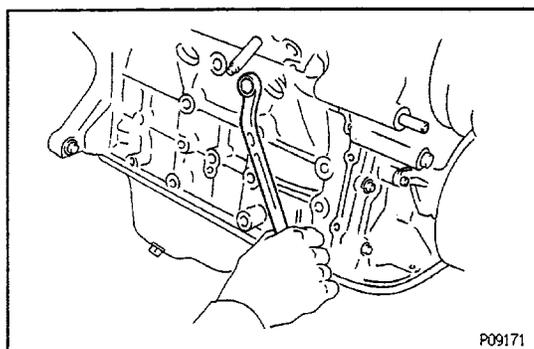
**9. INSTALL ENGINE COOLANT DRAIN PLUGS**
